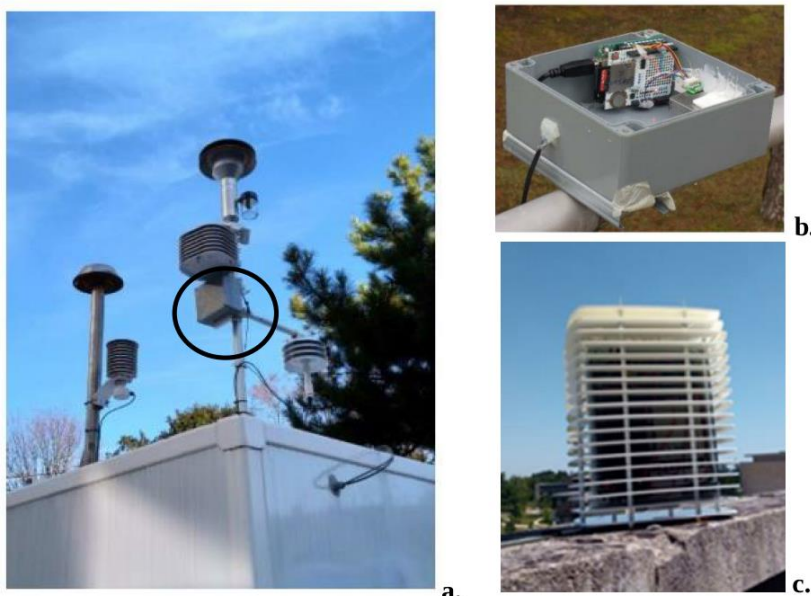
Figure 2. Le prototype de QameleO (Quality of Air Module for Environmental Learning Engineering and Observation), développé par l'Université de Bourgogne et l'Institut de Recherches pour le Développement, installé sur le toit de la station de référence des Péjoces d'ATMO Bourgogne-Franche-Comté en 2018 (a, cercle noir). En 2019, le prototype (b, dimensions 16 x 17 x 8 cm) devient la micro-station de mesures QameleO (c, dimensions 30 x 17 x 8 cm).
