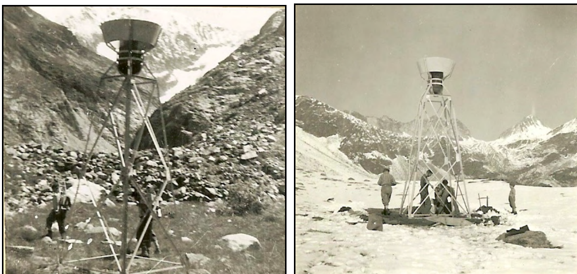
Figure 2 : Photographies des nivopluviomètres totalisateurs de « Roche Polie » à gauche et de « Notre Dame d'août » à droite. Pictures of the snow-rain totalizers from « Roche Polie » on the left and from « Notre Dame d'août » on the right side.
